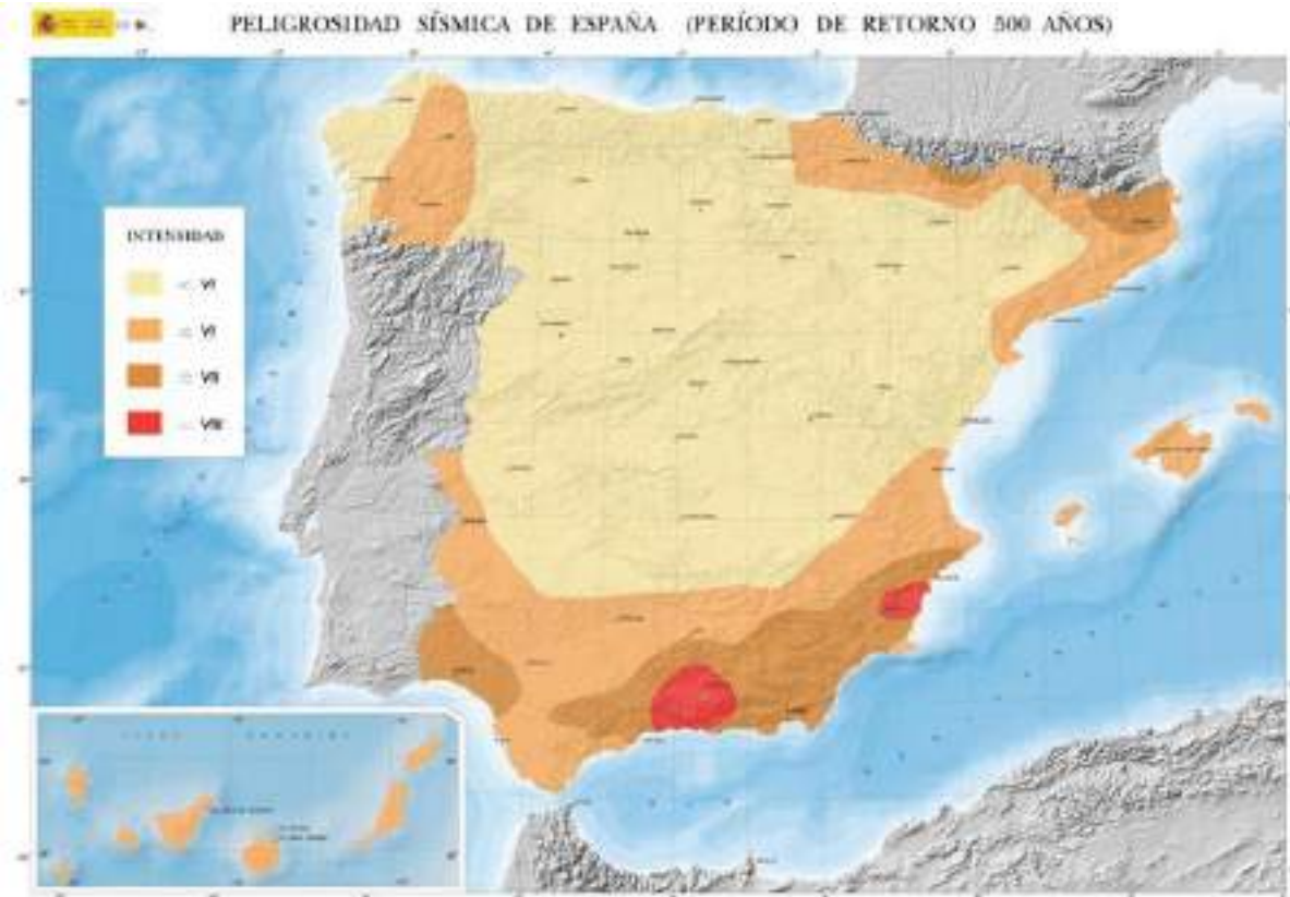
Figura 1. Peligrosidad sísmica de España (Período de Retorno de 500 años). Fuente: Instituto Geográfico Nacional (IGN).
